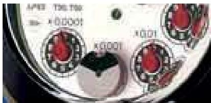
Абсолютная устойчивость системы передачи данных к воздействию внешнего магнитного поля благодаря применению стрелки с отражателем в качестве элемента оптической передачи данных из водосчетчика в радионакладку.
