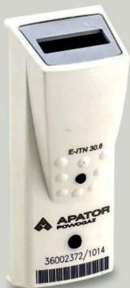
Предназначен для измерений, с помощью встроенных датчиков, температур прибора отопления и отапливаемого помещения и представления результата измерений нарастающим итогом в форме интеграла по времени, пропорционального отданной прибором отопления тепловой энергии.
