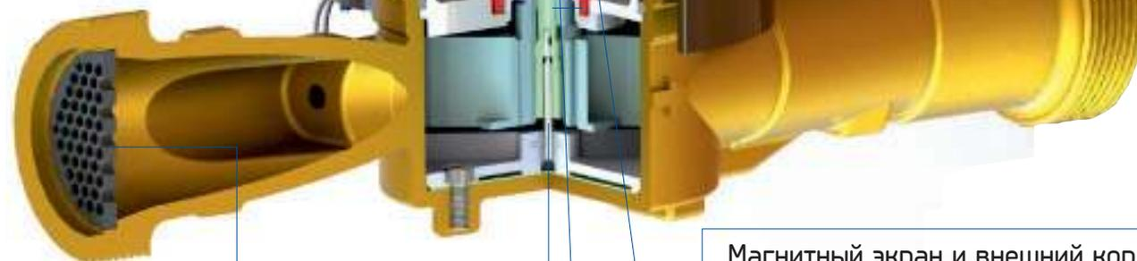
Ситечко на входе водосчетчика, защищающее от проникновения загрязнений в измерительный механизм.
